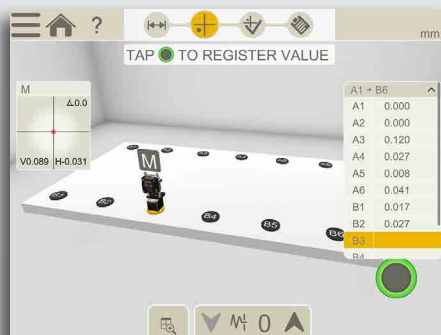
Programa Básico de medição de planicidade. Perfeito para fundações de máquinas, carcaças de compressores, etc.
