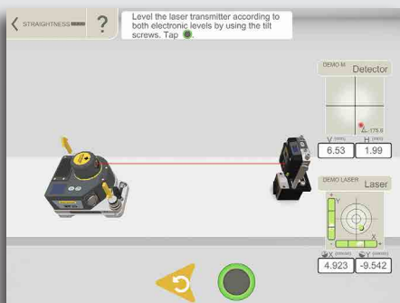
Calibrar os níveis de precisão eletrônica é muito fácil com a orientação passo a passo fornecida pelo software.
